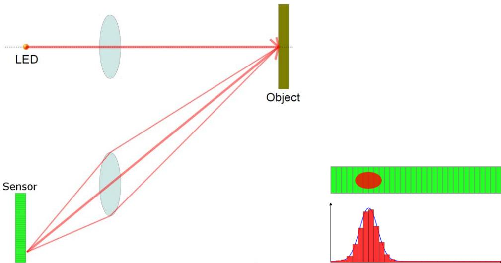
图6：三角定位传感器的原理与理想的传感器信号
