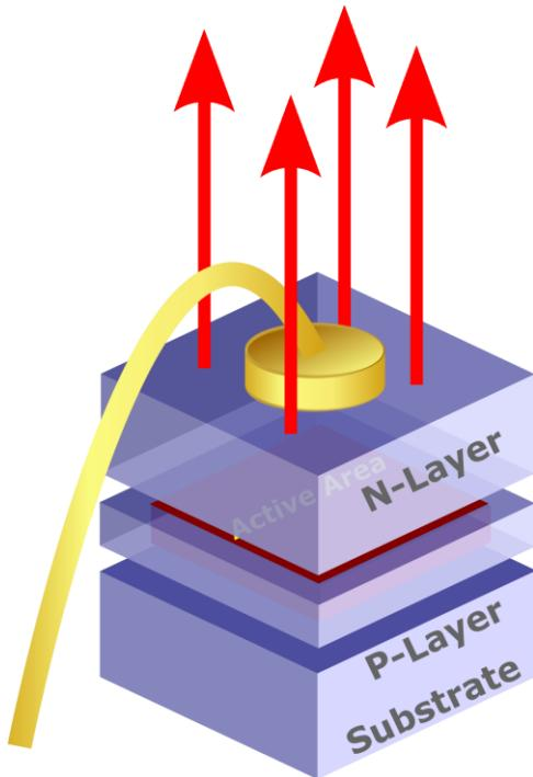
图2：修改后的表面光辐射LED的结构
