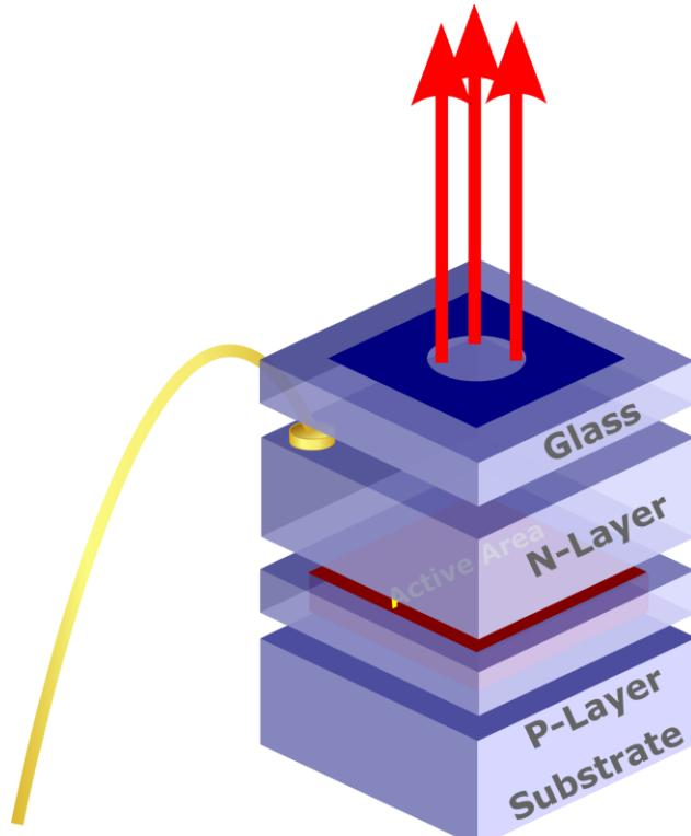
图3：掩膜点光源LED结构
