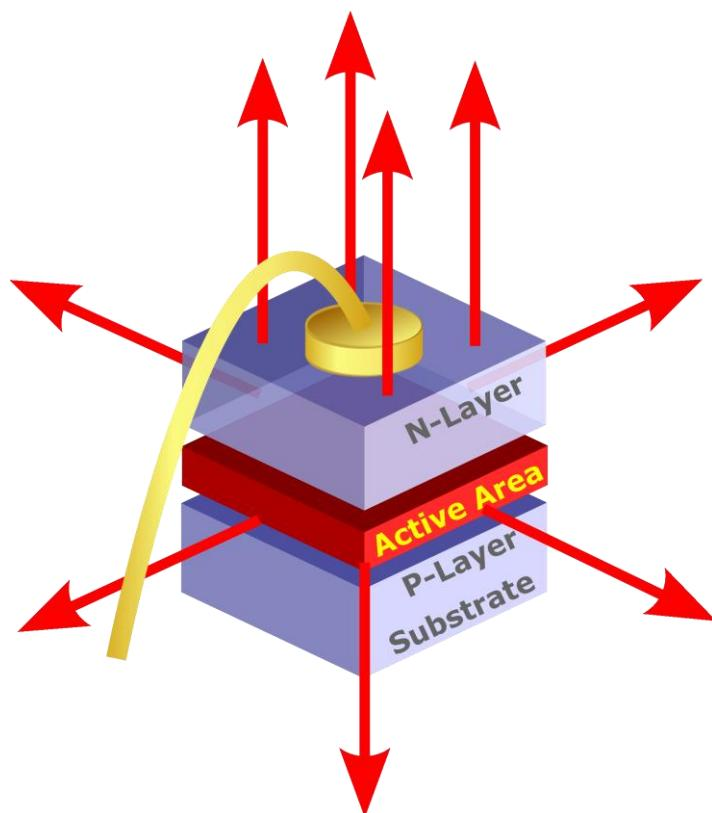
图1：LED的基本结构（体积光辐射）。
