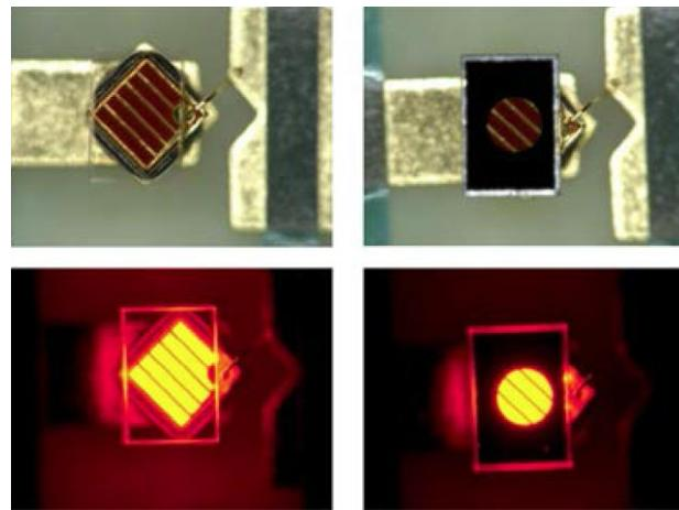
图4：在生产点光源LED时，有无掩膜对比图
